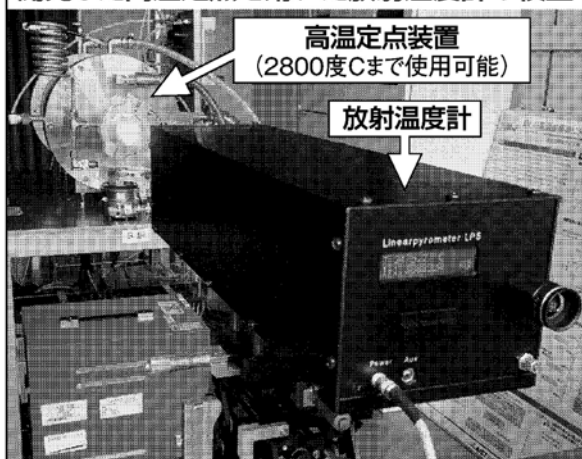
開発した高温定点を用いた放射温度計の校正
