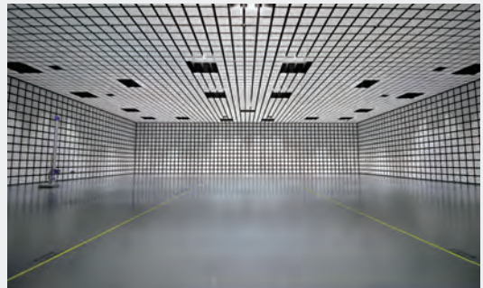
スマートシステム研究棟の電波暗室
