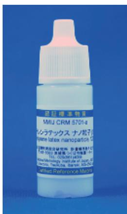
図5 液中粒子径認証標準物質（NMIJ CRM5701-a）
