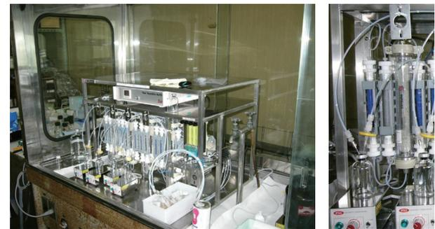
図3 メタンを二酸化炭素に変換しトラップする装置
