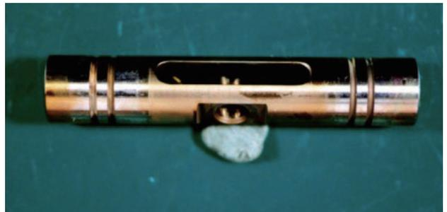
市販作動油により生じた油圧ポンプ試験機のサーボバルブ表面のラッカー皮膜（茶色部分）（著者らによる）
