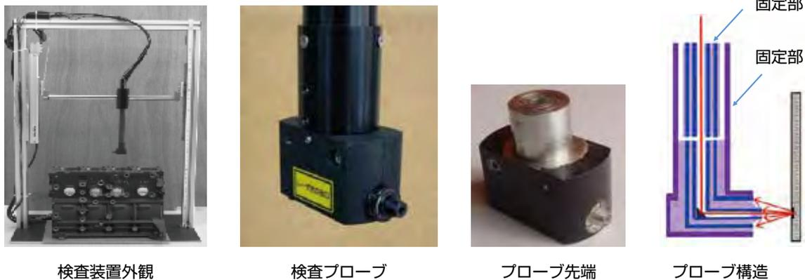
図11 加工穴内壁面検査装置
