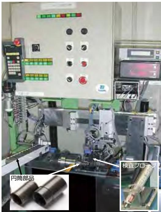
図10 自動車円筒部品の外面傷検査装置
