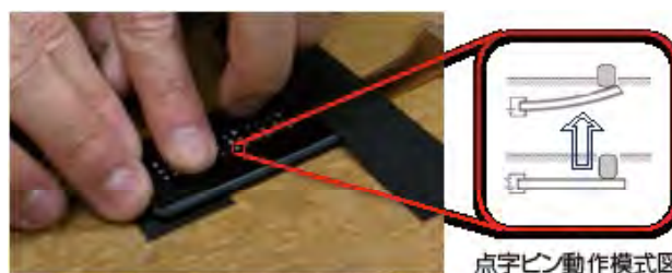
図6 バッキーゲルアクチュエータを用いた点字ディスプレイ
