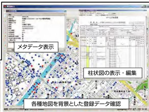
図7 ボーリングデータの変換プログラムと管理システム
