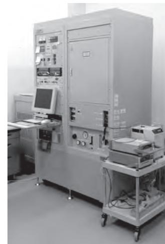
図7 熱拡散率の国家標準器
