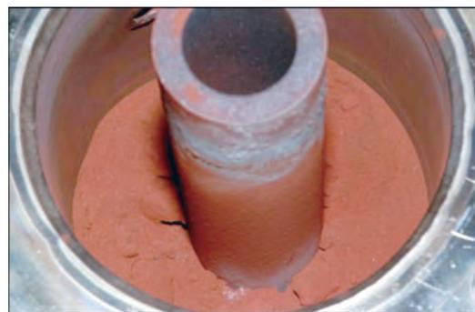
図6 汚泥燃焼実験後のフライアッシュの外観写真
