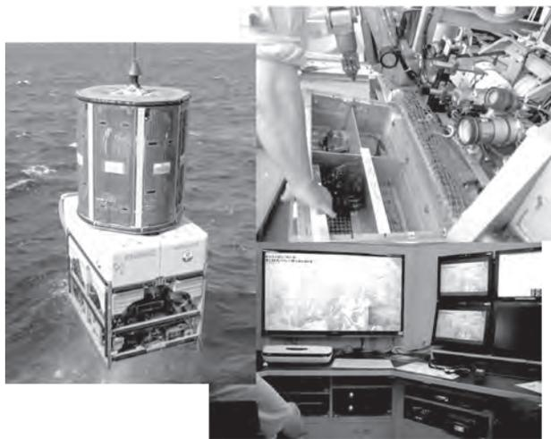
図7 GH12航海で使用した「白嶺」に搭載されている遠隔操作無人探査機（ROV）システム
