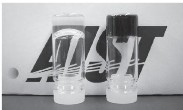
図4 倒立サンプル瓶中のヒドロゲルの写真(1 wt%濃度)
