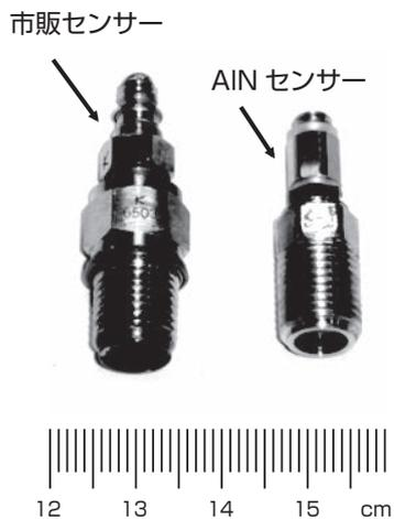
図12 試作したAlNセンサーの外観
