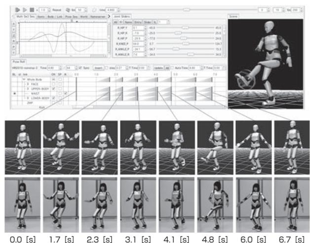
図5 全身動作振り付けシステムの動作編集画面と作成した動作（キーポーズ）の例
