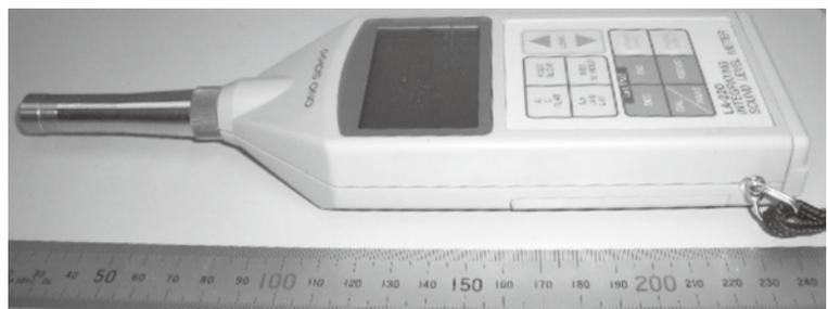
図1 計測用マイクロホン(左)と騒音計(右)
