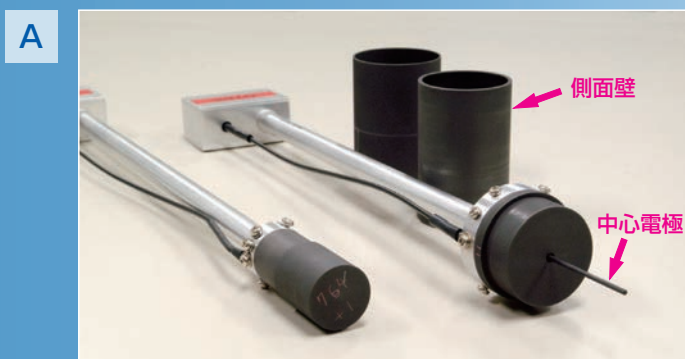
図A グラファイト壁空洞電離箱(右:側面壁をはずしている) ガンマ線の線量を正確に測定することができる国家標準器。
