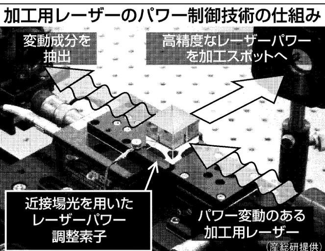
と考えた。レーザーの透過や反射を調節する光学素子が不可欠である。しかし、加工用レーザーの特徴である高いパワーやふぞろいの偏光が障壁となり、既存の光学素子をパワーの制御に用いることは困難であった。
