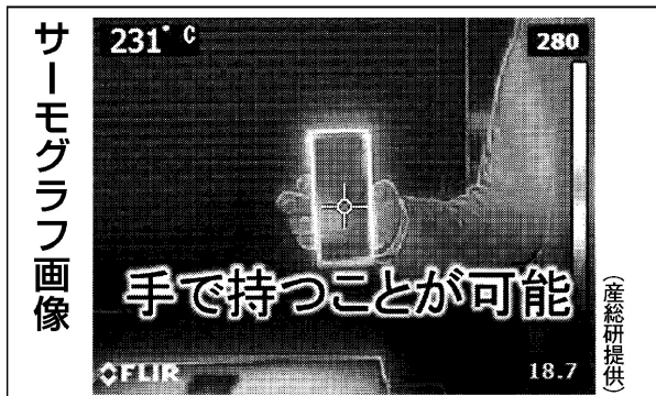
開発したレンガは、熱容量が小さいため、加熱後、231°Cになっても素手で持てる
