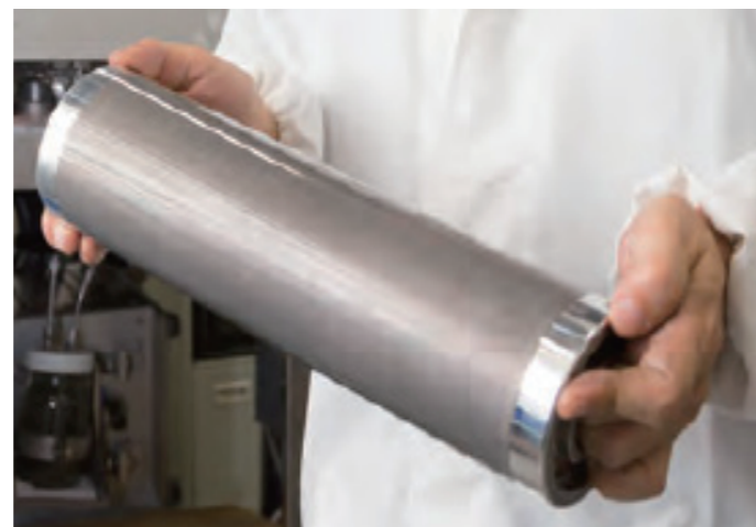
両端の金属光沢を除き、灰色部が硬質なアルミナコーティング
