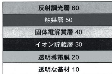
図 本開発の調光ミラーデバイスの構造
