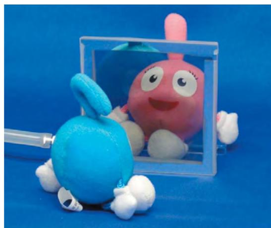
図 マグネシウム・カルシウム合金薄膜を用いた調光ミラー（左：鏡状態、右：透明状態）
