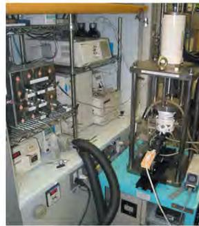
極微量試料に対応した溶解度の測定装置
