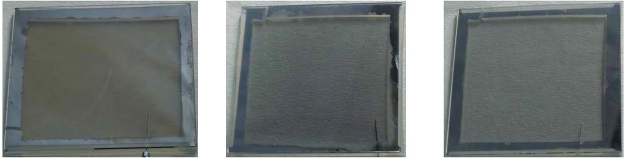
図 調光ミラー用薄膜材料の透明状態における比較
