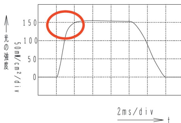
本技術による改良型PFN回路図を用いた場合のフラッシュランプの発光波形
