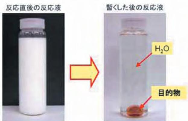
図3 高温高压水-マイクロリアクターシステムによって行われた反応後の様子(クライゼン転位、収率98%)
