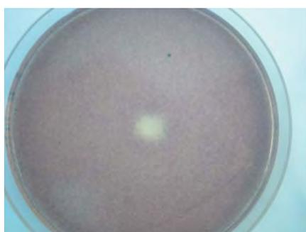
ダイヤモンドLEDによる紫外線照射で大腸菌を殺菌した様子。シャーレ全体に分散させた大腸菌に2mmの距離からダイヤモンドLEDにより紫外線を照射し、24時間培養した後の状態。中央の直径10mm程度の透明な部分は、紫外線照射により大腸菌が死滅した領域である。
