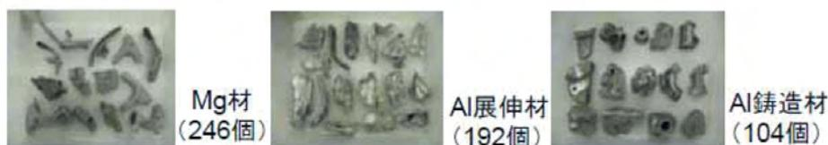
図2 廃車シュレッダー工場から入手した破砕片（20～200 mm程度）
