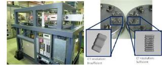
(開発したX線源と分解能試験)
