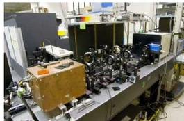
過渡吸収分光装置、蛍光寿命計測装置
