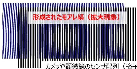
拡大現象である**モアレ縞の位相を解析**することで、大幅な精度向上を実現。繰り返し模様をデジタルカメラまたは顕微鏡で画像撮影するだけで、**高精度な変位・ひずみ分布が瞬時に得られる**。
