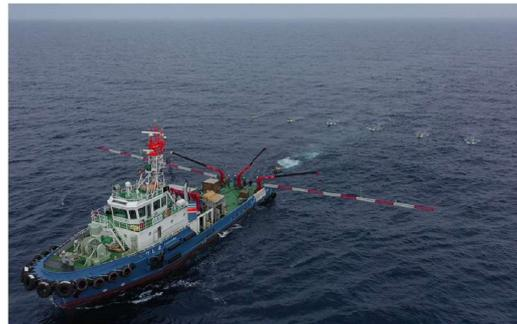
高分解能海上三次元地震探査
