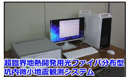
超臨界地熱開発用光ファイバ分布型坑内微小地震観測システム
