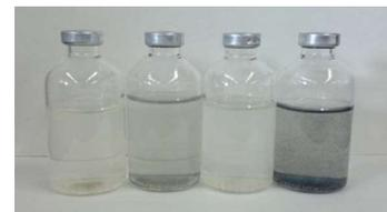
クロロエチレン分解促進と阻害要因解明のための培養実験の様子
