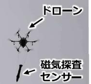
ドローン吊り下げ型磁気探査システム
