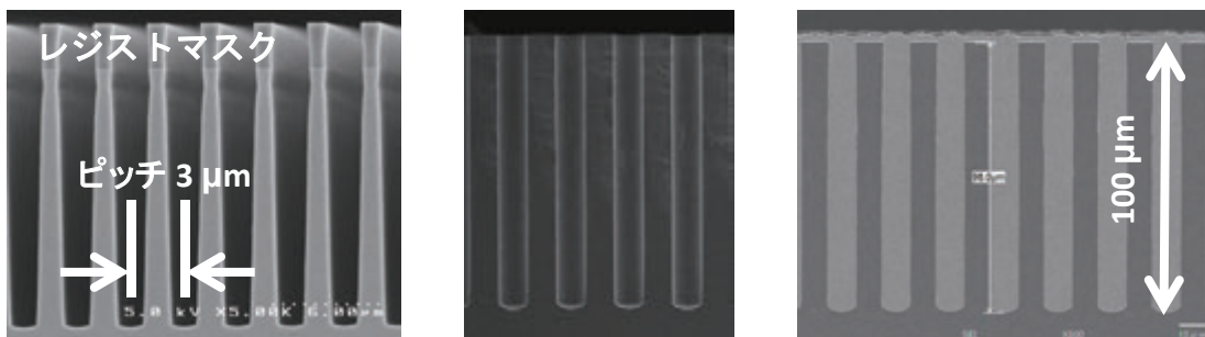
深掘りエッチング装置によるSi基板のトレンチ加工(左)、ホール加工(中)、Cu埋め込み(右)
