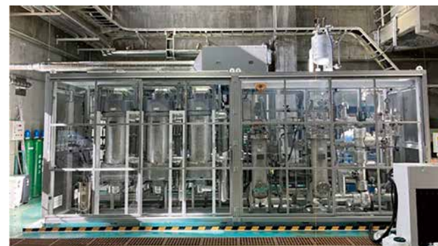
直接LPG合成用ベンチスケール試験装置（産総研つくば西事業所）
