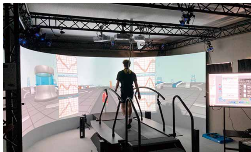
図2 歩行時の挙動を再現・解析するVR連動型トレッドミル歩行システム
