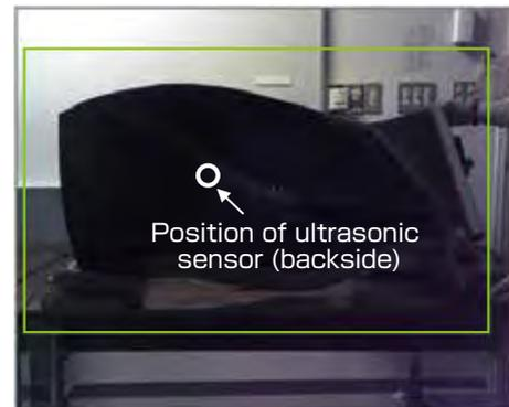
**Fig. 8 CFRP aircraft fan blade**
