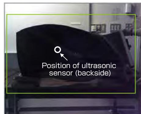
**Fig. 8 CFRP aircraft fan blade**
