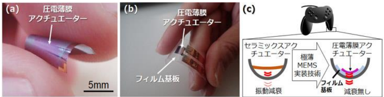
(a)世界最薄のハプティクス用圧電薄膜アクチュエーター、(b)フィルム基板に実装したハプティクスフィルム、 (c)ハプティクスフィルムを曲面に沿って貼り付けたコントローラーのイメージ図
