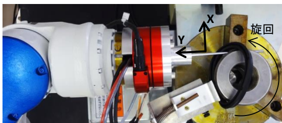
図1 パッキン取り付け作業
