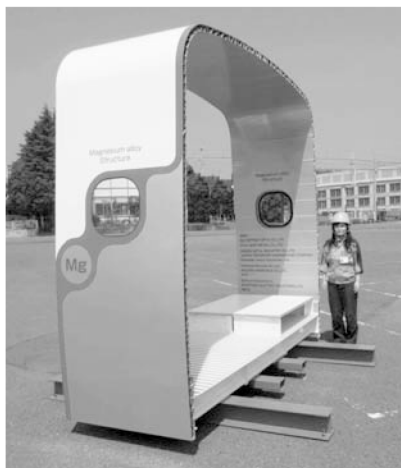
試作した高速鉄道車両部分構体の外観
