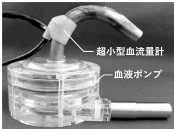
産総研で開発中の血液ポンプと超小型血流量計
