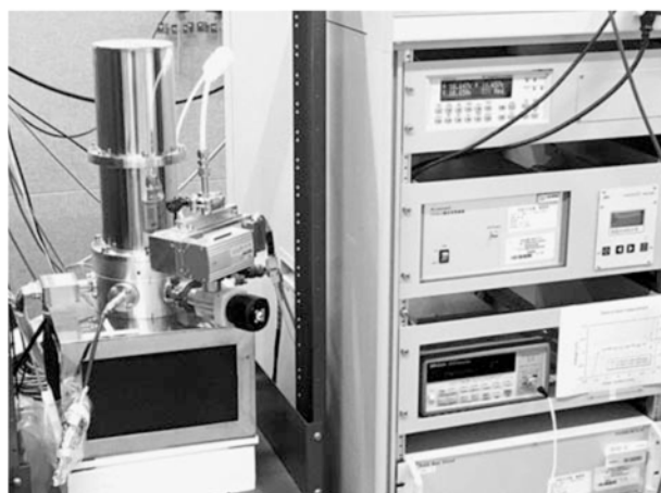
小型冷凍機⑤を用いた直流電圧の国家標準システム
