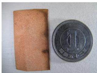
スーパーグロースCNTを用いたCNT銅複合材料
