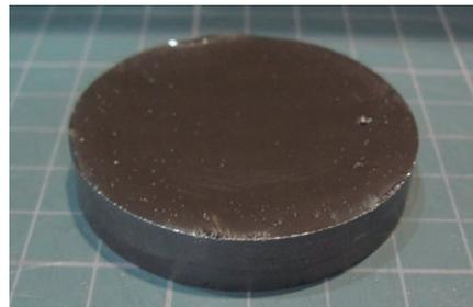
溶液法による 4H-SiC バルク単結晶
