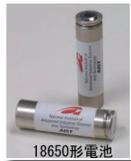
新材料を検証するプロトタイプ電池
