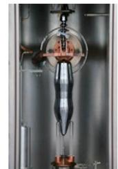
質量5 kgの  $^{28}\text{Si}$  同位体濃縮結晶
