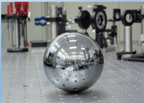
左：プランク定数精密測定のために作成された質量1 kgのシリコン単結晶球体。この球体の質量、体積、モル質量、格子定数を測定することで球体内のシリコン原子を数え、プランク定数を決定する。右：シリコン単結晶球体の体積を測定するためのレーザー干渉計。レーザー波長の精密制御により、球体形状を1ナノメートルよりも良い精度で計測する。
