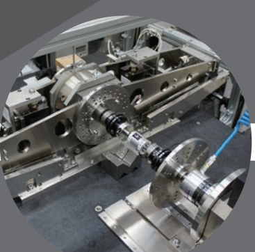
10 N·m 実荷重式トルク標準機
