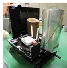
現場に搬入組立可能な X線撮像装置
