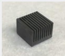
金属分散した固体相変化蓄熱部材
