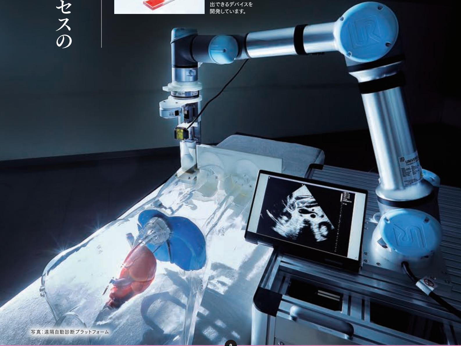
写真：遠隔自動診断プラットフォーム
