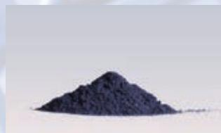
プルシアンブルー型錯体によるアンモニアの吸着回収と、窒素の再利用技術の開発を進めています。
