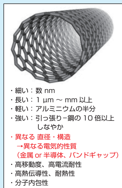
図1 カーボンナノチューブの構造と特徴
