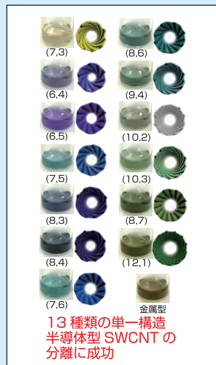
図3 今回の手法によって市販のSWCNTから分離した13種類の単一構造半導体型SWCNTの分散液と軸方向からみた分子モデル図 図中の数字(n,m)は、SWCNTの構造を表す指数。
