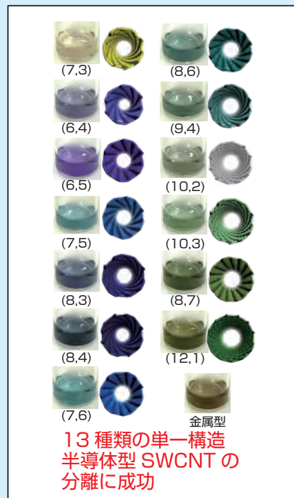
図3 今回の手法によって市販のSWCNTから分離した13種類の単一構造半導体型SWCNTの分散液と軸方向からみた分子モデル図 図中の数字(n,m)は、SWCNTの構造を表す指数。
