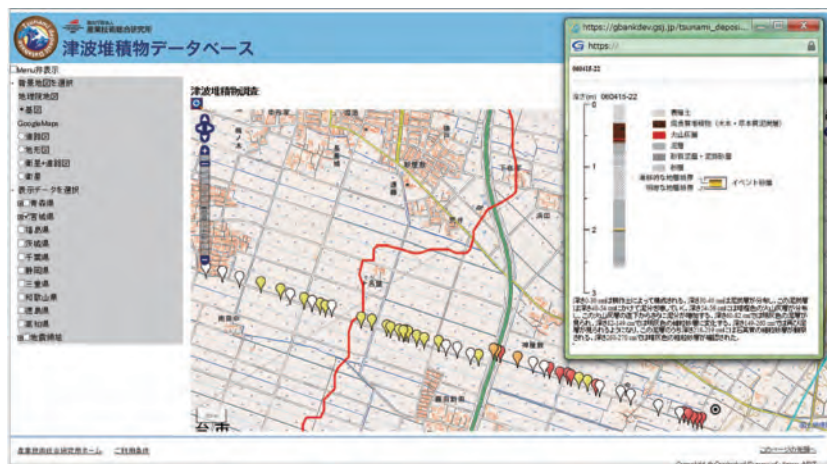
津波堆積物データベースの表示例(仙台平野北部周辺) 地図上に示されたアイコンをクリックすることで、地質柱状図が表示される。
