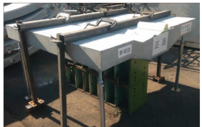
図2 複数の疑似欠陥（空洞やひび割れ）をもつコンクリート供試体。正面から見て左側（写真の手前側）は通常のコンクリート表面、右側（写真の奥側）は炭素繊維シートで覆われた表面。
