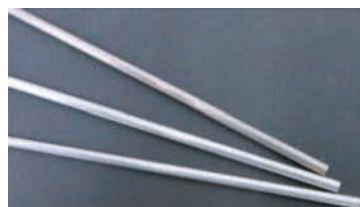
図1 開発した押出し技術により作製した長尺マグネシウム合金押出し細管
