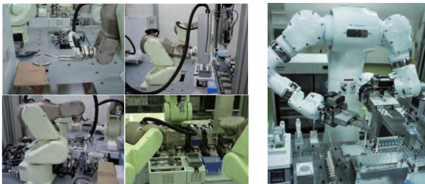
図1 「1ロボット1工程」方式のベンチワークロボット 図2 汎用ヒト型ロボット「まほろ」
