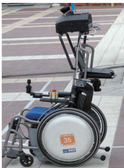
図1 自律走行車いす「Marcus」 背もたれ上部に3D環境地図作成用センサーを搭載
