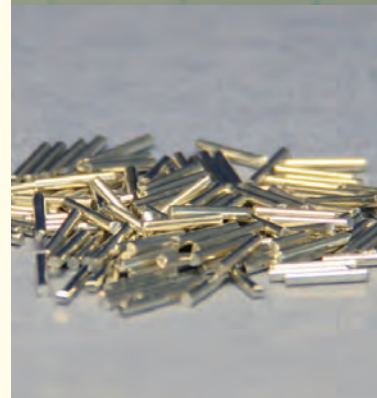
上：半導体微細加工技術で製作した回転軸保持機構 (p.15) 下：鉛フリーはんだチップ認証標準物質 (p.16)
