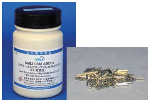
図1 鉛フリーはんだチップ認証標準物質 (Pb 高濃度) Pbの認証値は949.2 mg/kg ± 12.8 mg/kg。±以降は包含係数2の拡張不確かさを表す。
