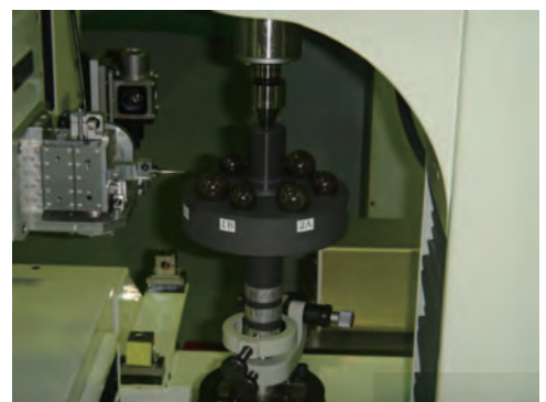
図2 基準器による歯車測定機の測定精度検査の例
