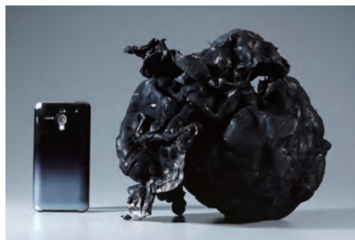
図1 開発した工業生産プラントで合成した単層カーボンナノチューブの塊(左は比較のためのスマートフォン)
