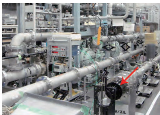
図1 気体流量標準設備に取り付けられた流量・流速変換ノズル(右下の矢印)
