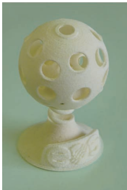
図2 3Dプリンターで製作した3重球殻
