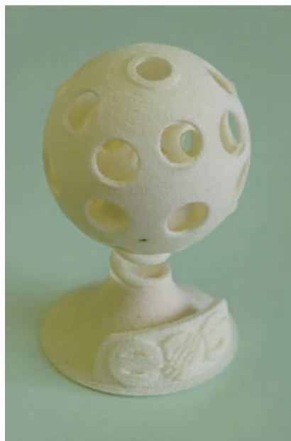
図2 3Dプリンターで製作した3重球殻
