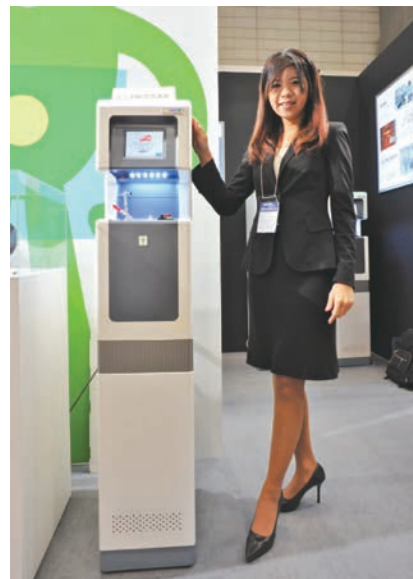
図2 人サイズのミニマル製造装置 (高さ1440 mm、幅294 mm、奥行450 mm)
