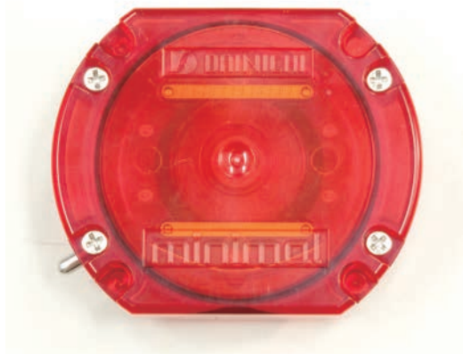
図1 UV光カットウエハー搬送容器～ミニマルシャトル
