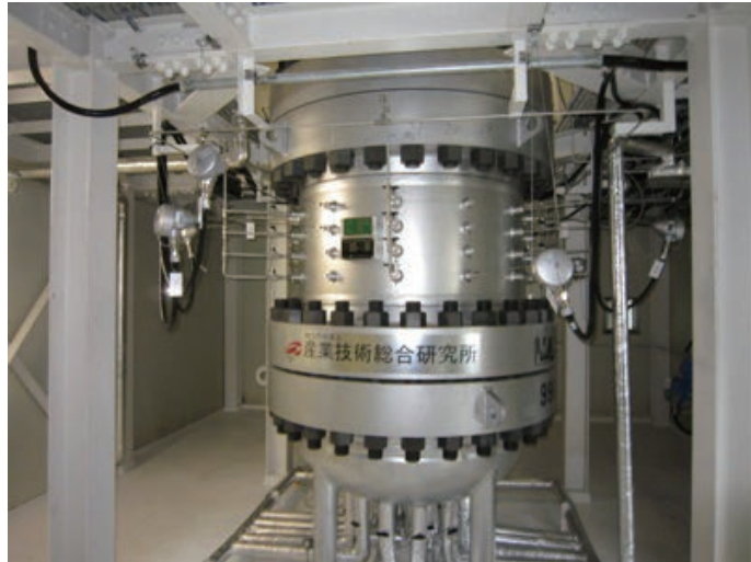
生産増進法の開発や流動特性、力学特性などを解析するための大型室内産出試験装置
