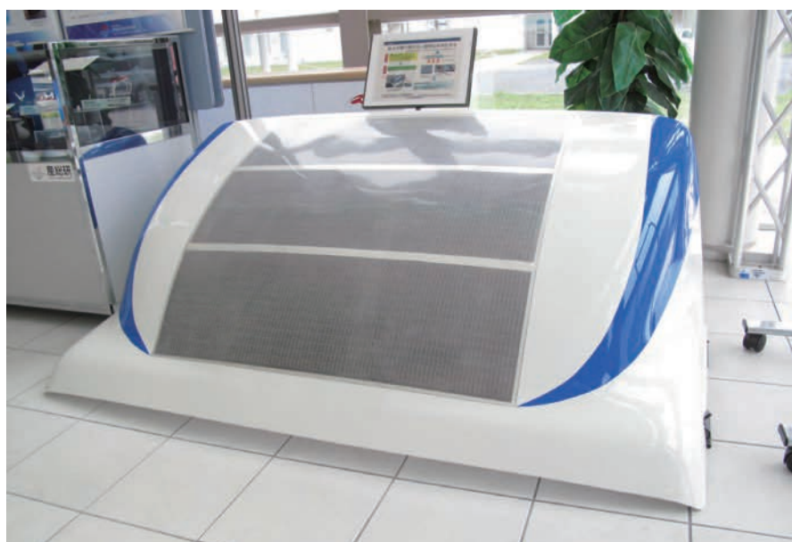
透明不燃プラスチックを用い成形された、フレキシブル太陽電池内蔵トラック部品
