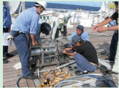
調査に使用する発振装置（エアガン的一种）の調整の様子
