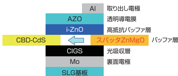
図1 評価を行った CIGS 太陽電池のデバイス構造
