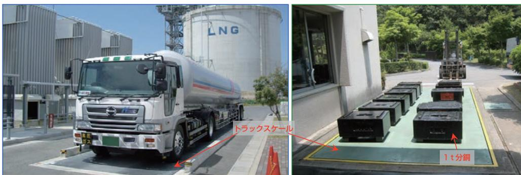
図1 大型トレーラーをトラックスケールで計量している様子(左)、大型分銅を使用してトラックスケールを検査している様子(右)
