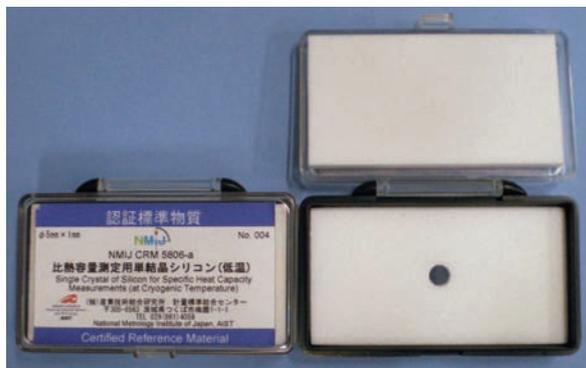
写真 比熱容量測定用単結晶シリコン (低温)、NMIJ CRM 5806-a
