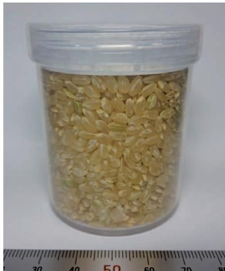
図 放射性セシウムを含む玄米の認証標準物質 (NMIJ CRM7541-a)
